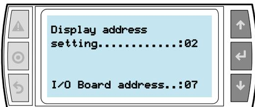
2. Establecer la dirección del display, 0 para conexiones punto a punto. Confirmar pulsando Intro.
